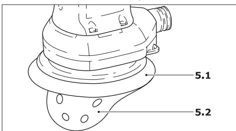
Les abrasifs autoagrippant (5.2) sont facilement placés sur le patin de ponçage (5.1) puis maintenus en toute sécurité par le revêtement autoagrippant du patin de ponçage Stickfix.
